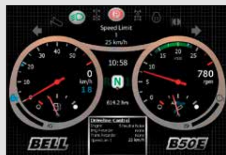
Kontroller for maksimal hastighet kan aktiveres både av sjåføren og av forvalgte innstillinger for automatisk redusering av fart.
