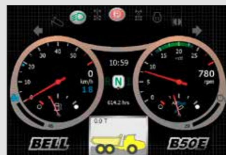
Integrert lastevkt gir sjåføren sanntidsinformasjon om nyttelasten mens maskinen lastes. Det kan også aktiveres en modus for hastighetsbegrensning hvis maskinen er betydelig overlastet.
