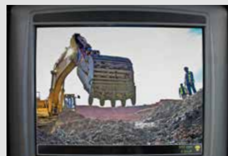
Det integrerte ryggekamera i monitoren er standard på alle modeller.
