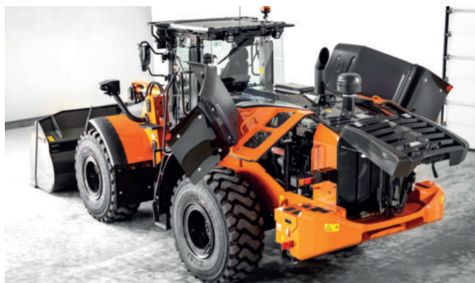
Motorhuv med enkel åtkomst för dagliga inspektioner.
