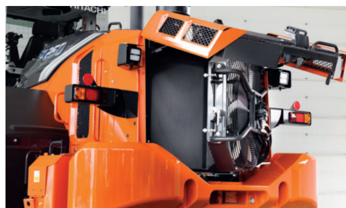
Intelligent fläktsystem förhindrar att kylarna täpps till.
