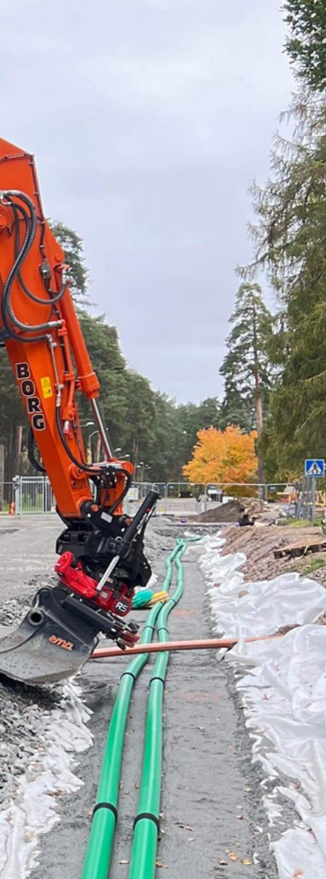
En specialkonstruerad gripgallerskopa på John Borks ZX300LC-7 underlättar arbetet med översvämningsprojektet vid Kårböle.
