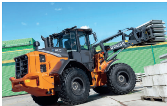
ZW160-7 i PL-version med parallellförd lyftarm ökar kontrollen vid lastning och avlastning.
