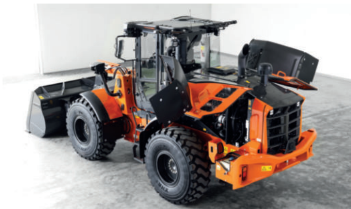
Motorhuv med enkel åtkomst för dagliga inspektioner.
