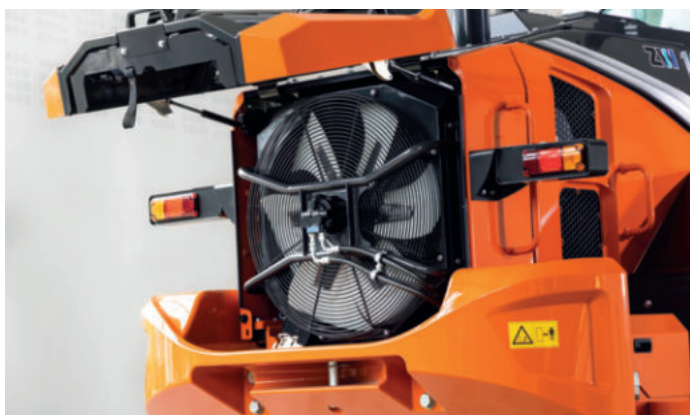
Intelligent fläktssystem förhindrar att kylarna täpps till.
