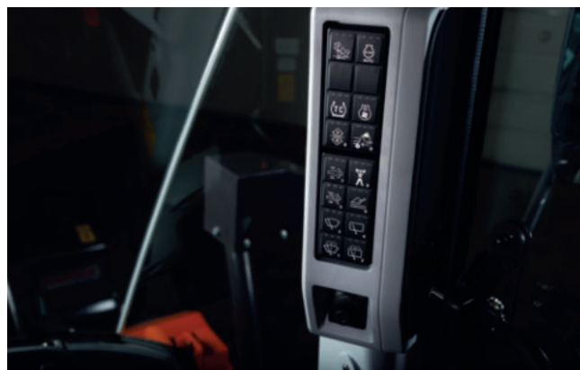
Alla funktioner som används ofta kan lätt väljas genom en snabb titt på omkopplaren på sidopanelen.
