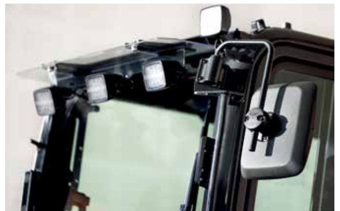
Omplacerade bom- och förarhyttslampor ökar sikten under tuffa förhållanden.
