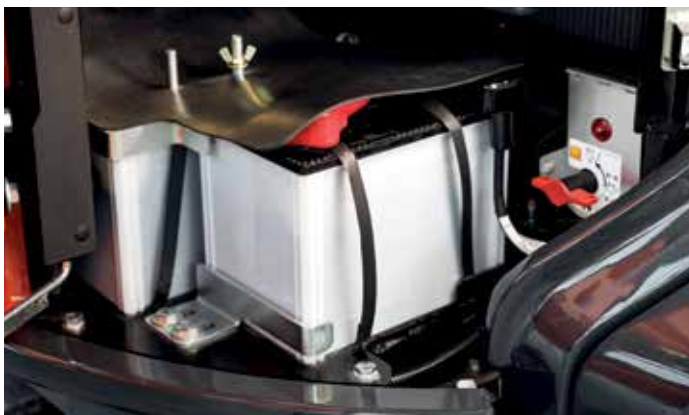
Både automatisk och manuell batterifrånskiljare.
