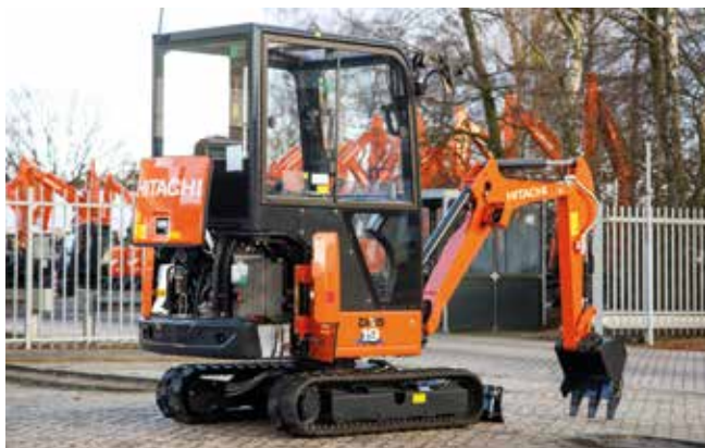
Motorhuven skjuts upp vertikalt, vilket är perfekt i trånga utrymmen.
