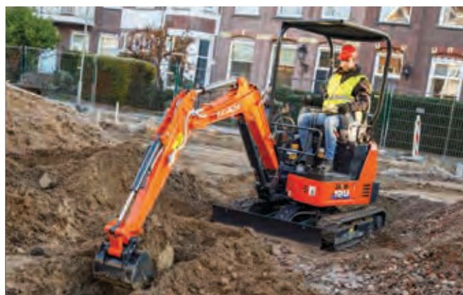
Larvbanden går att bredda för förbättrad mångsidighet och stabilitet.
