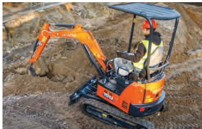
Skyddstak med tre stolpar förbättrar sikt.
