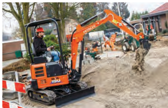
Kort bakdel med snäv svängradie är idealiskt för att arbeta i trånga utrymmen.
