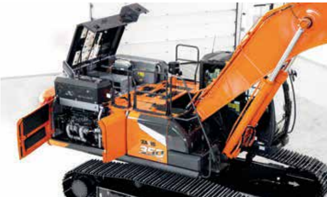
Motorhuv med gasdämpare (ZX300/ZX350) gör åtkomsten enkel.
