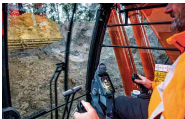
Parallellförd vindrutetorkare med större täckning förbättrar sikten.
