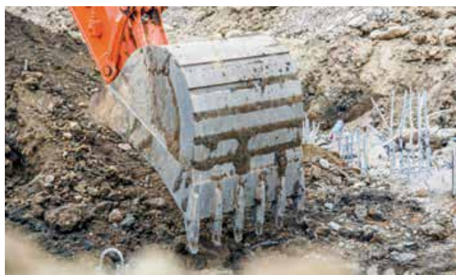
Hitachi-GET inkluderar självslipande tänder och tillförlitliga adapttrar som säkerställer en precis passning.
