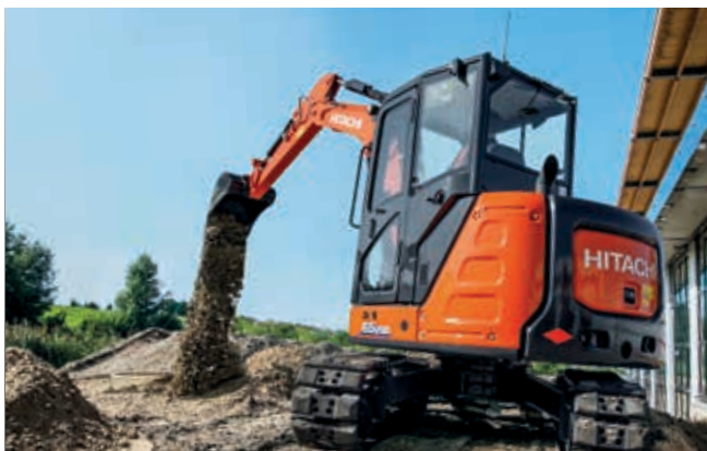
Den korta bakdelens svängradie hos ZX65USB-6 är idealisk för arbete där utrymmet är snävt.
