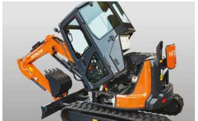
Det lutande golvet gör det enkelt att komma åt motorn och styrventilen för snabbservice.
