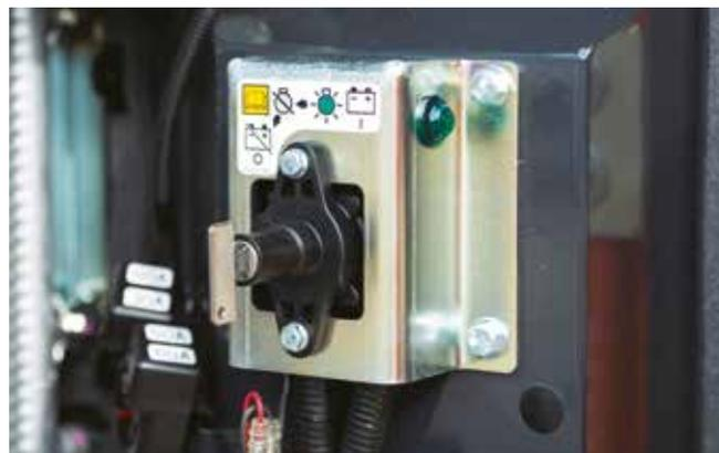
Batterifrånskiljaren innebär att underhåll kan utföras på ett säkert sätt.
