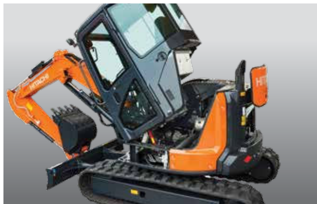
Det lutande golvet gör det enkelt att komma åt motorn och styrventilen för snabbservice.
