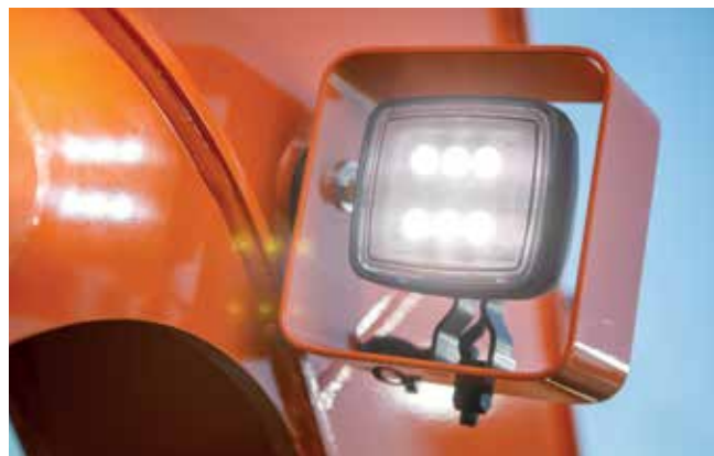
LED-lampor har en längre livslängd än halogenalternativen.
