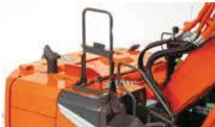
Ny högre lejdare på ZX225US/USR-7 som är fällbar för enkel transport.
