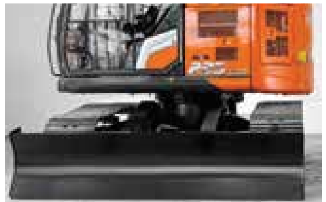
Den ultrakorta svänggraden och valfritt schaktblad i ZX225US-7 ökar mångsidigheten.
