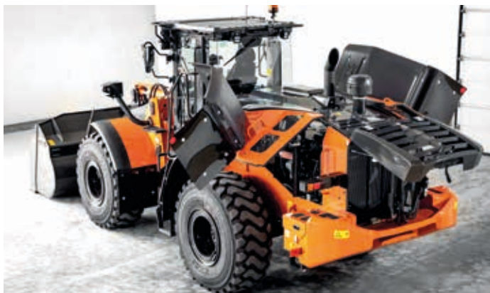
Motorhuv med enkelt åtkomst för dagliga inspektioner.
