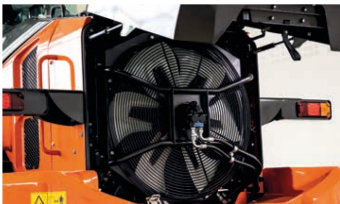
Intelligent fläktsystem förhindrar att kylarna täpps till.
