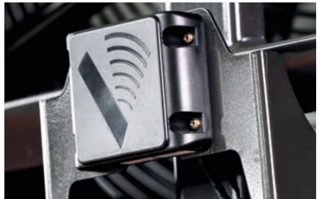
Backradarsystem ökar säkerheten på arbetsplatsen.
