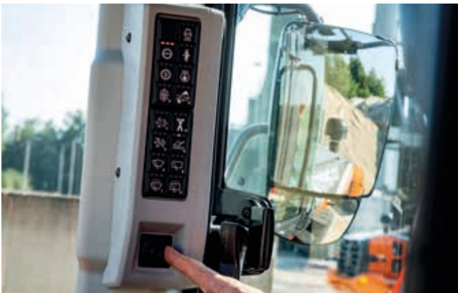
Elektriskt justerbara speglar ger en tydlig bild bakom maskinen.
