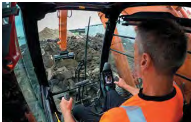
Parallell vindrutetorkare med större täckningsarea både på övre och undre vindrutan förbättrar sikten.
