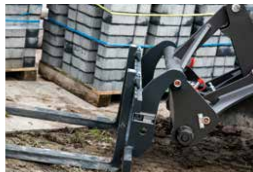
Redskap monteras säkert och snabbt med hydrauliskt redskapsfäste.
