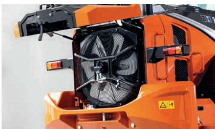
Intelligent fläktssystem förhindrar att kylarna täpps till.
