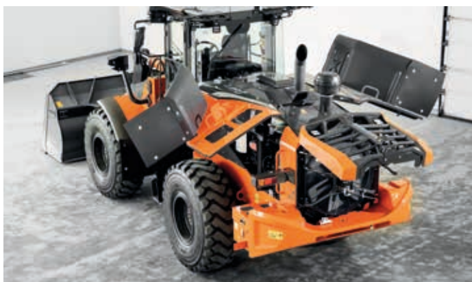
Motorhuv med enkel åtkomst för dagliga inspektioner.
