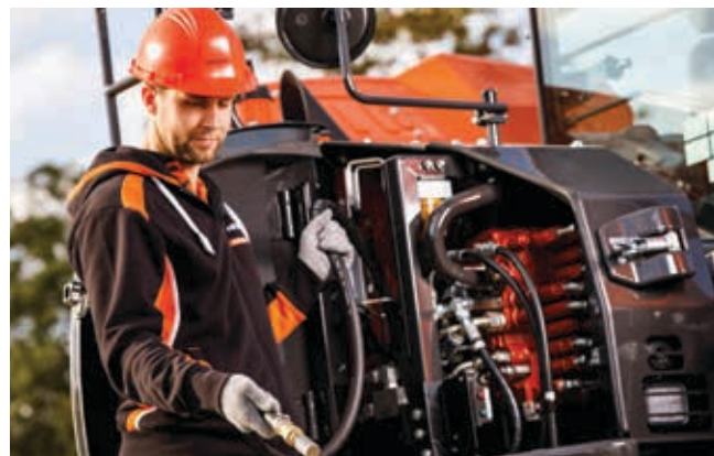
Grävmaskinen kan tankas med en elektrisk pump.
