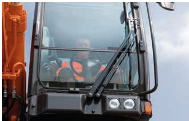
Parallellförd vindrutetorkare med större täckning förbättrar sikten.
