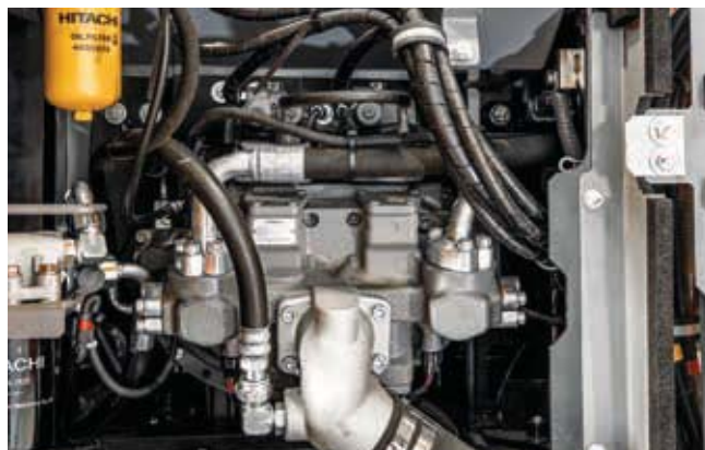
HIOS IV-hydraulsystemet åstadkommer en bränslebesparing på upp till 7 %.
