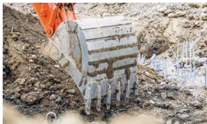
Hitachi-GET inkluderar självslipande tänder och tillförlitliga adaptrar som säkerställer en precis passning.
