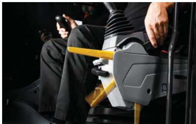
Ny utformning av säkerhetsspaken medför förbättrad säkerhet.
