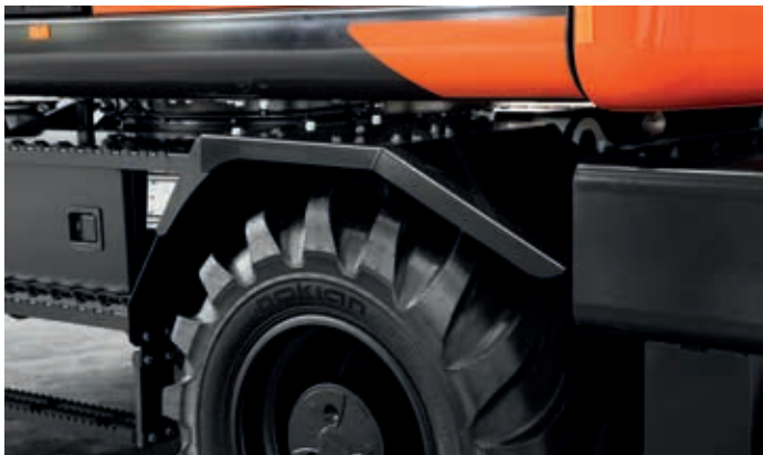
Stänkskärmar på undervagnen skyddar överdelen och lamporna från smuts, och hjälper till att hålla maskinen ren.
