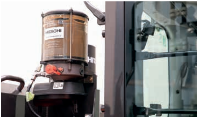
Centralsmörjningen (tillval) sparar tid.
