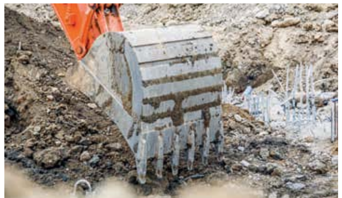
Hitachi-GET inkluderar självslipande tänder och tillförlitliga adapttrar som säkerställer en precis passning.
