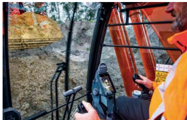
Parallellförd vindrutetorkare med större täckning förbättrar sikten.
