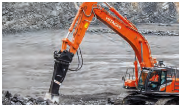
Hitachi-hydraulhammare är lätta och har hög anslagsenergi.
