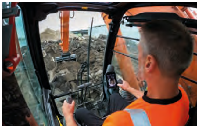
Parallellförd vindrutetorkare med större täckning förbättrar sikten.
