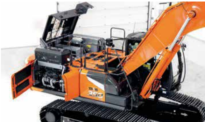
Motorhuv med gasdämpare (ZX300/ZX350) gör åtkomsten enkel.
