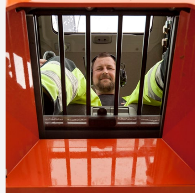
Siktfönstret i hyttens golv gör att Patrik Backström kan se ner i schakten. Tack vare att hytten vilar på glidskenor kan hytten skjutas framåt.
