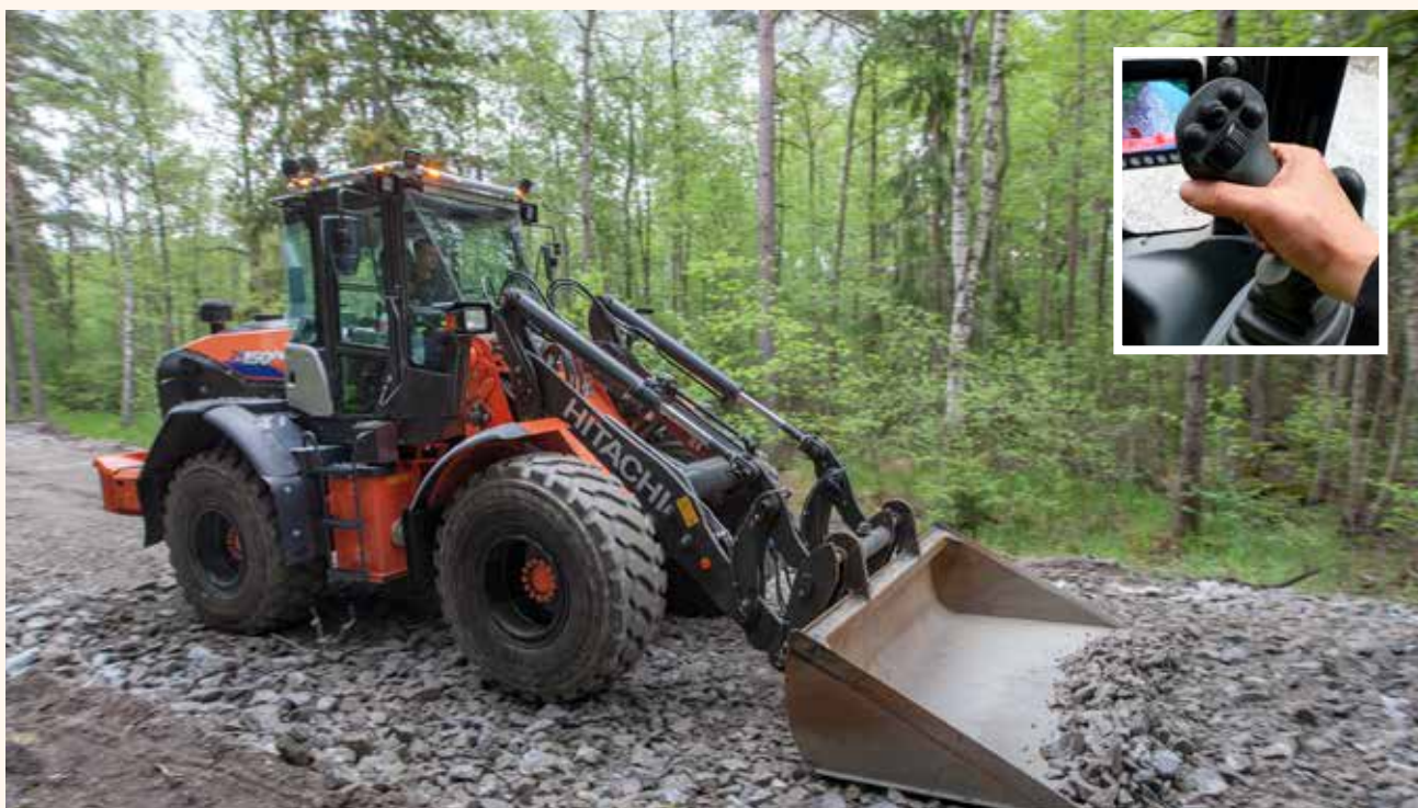
Hjullastaren har L8-spak och inch på bromspedalen.
