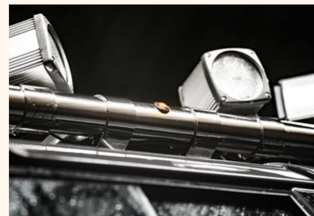
Bågarna på maskinen och hyttens tak är måttbeställda och tillverkade i rostfritt stål. Masterna till maskinstyrningen är infällda i bågen.
