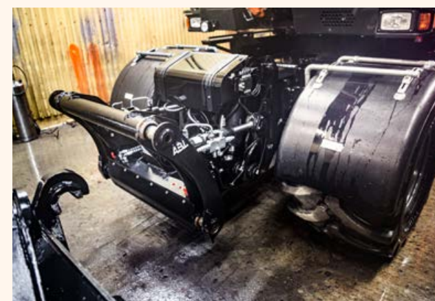
Maskinen har 650-däck med medföljande skärmar, samt tiltbart BM-fäste för materialskopa.
