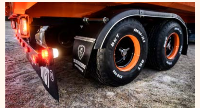
Egentillverkade skärmar, underkörningsskydd och stänklappar pyntar vagnen.
